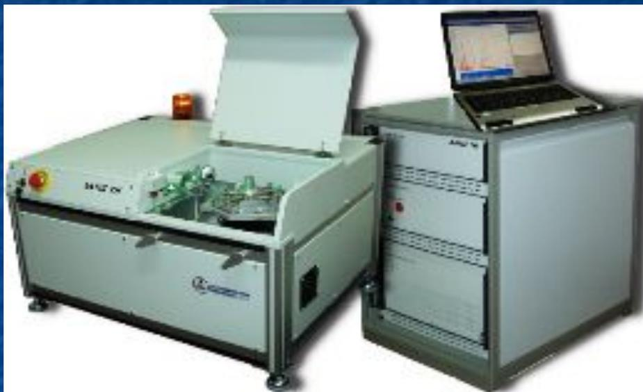
1. Источник возбуждения плазмы – двухимпульсный Nd:YAG лазер, с частотой повторения импульсов до  $f_l = 10$  Гц и максимальной энергией излучения до  $E_{имп} = 110$  мДж и работает на длине волны  $\lambda = 1064$  нм.
