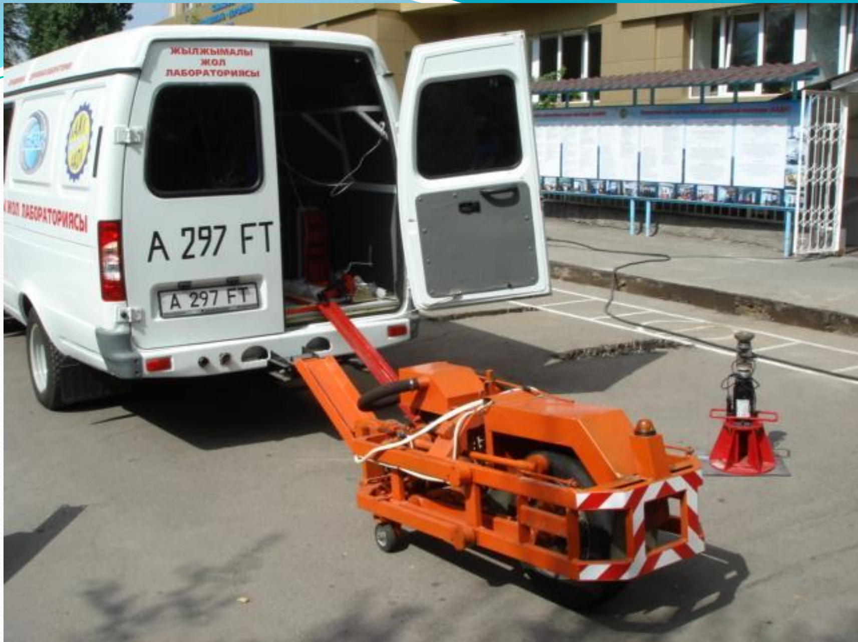
Передвижная дорожная лаборатория ПКРС-2У в рабочем положении
