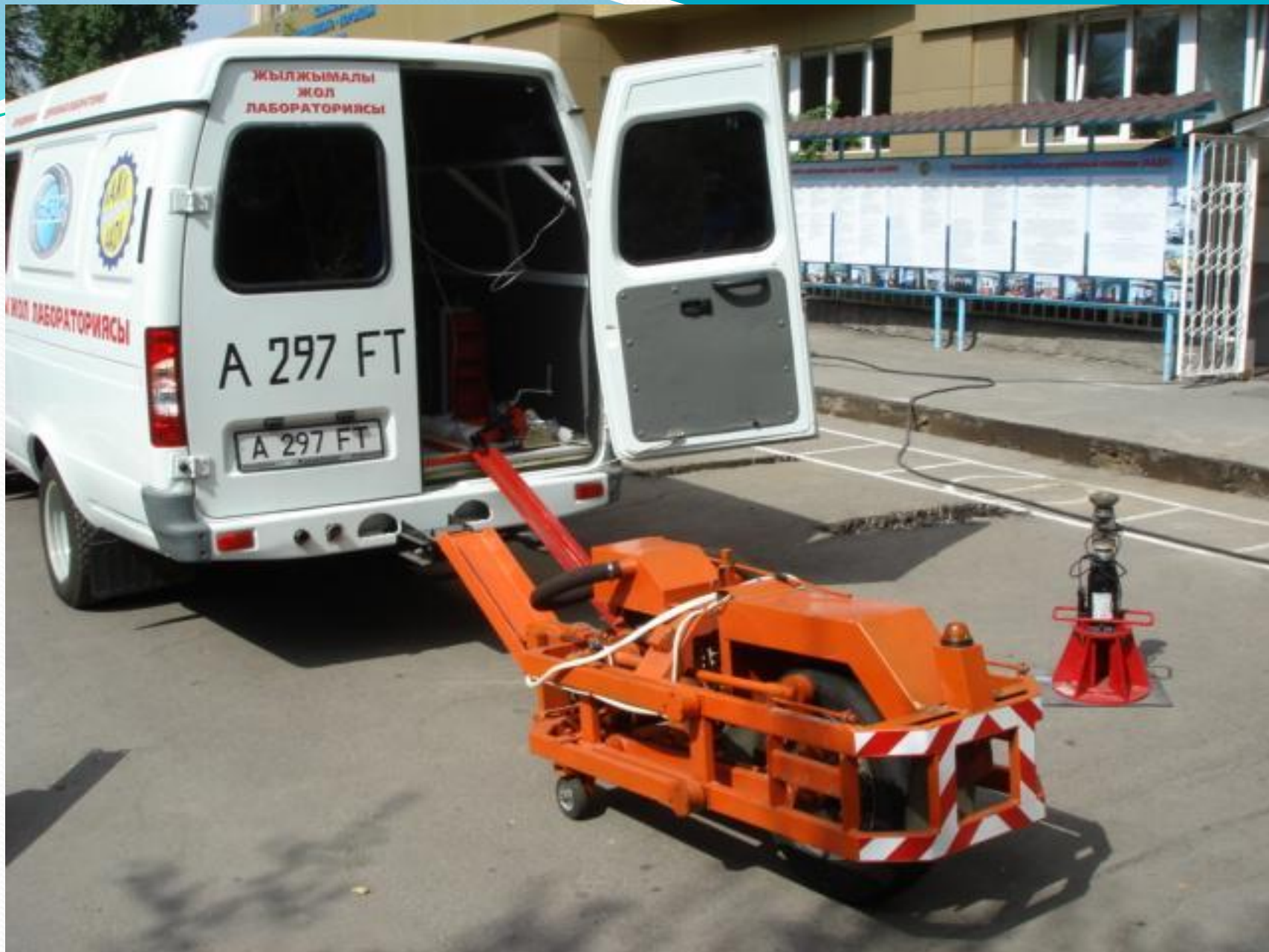
Передвижная дорожная лаборатория ПКРС-2У в рабочем положении
