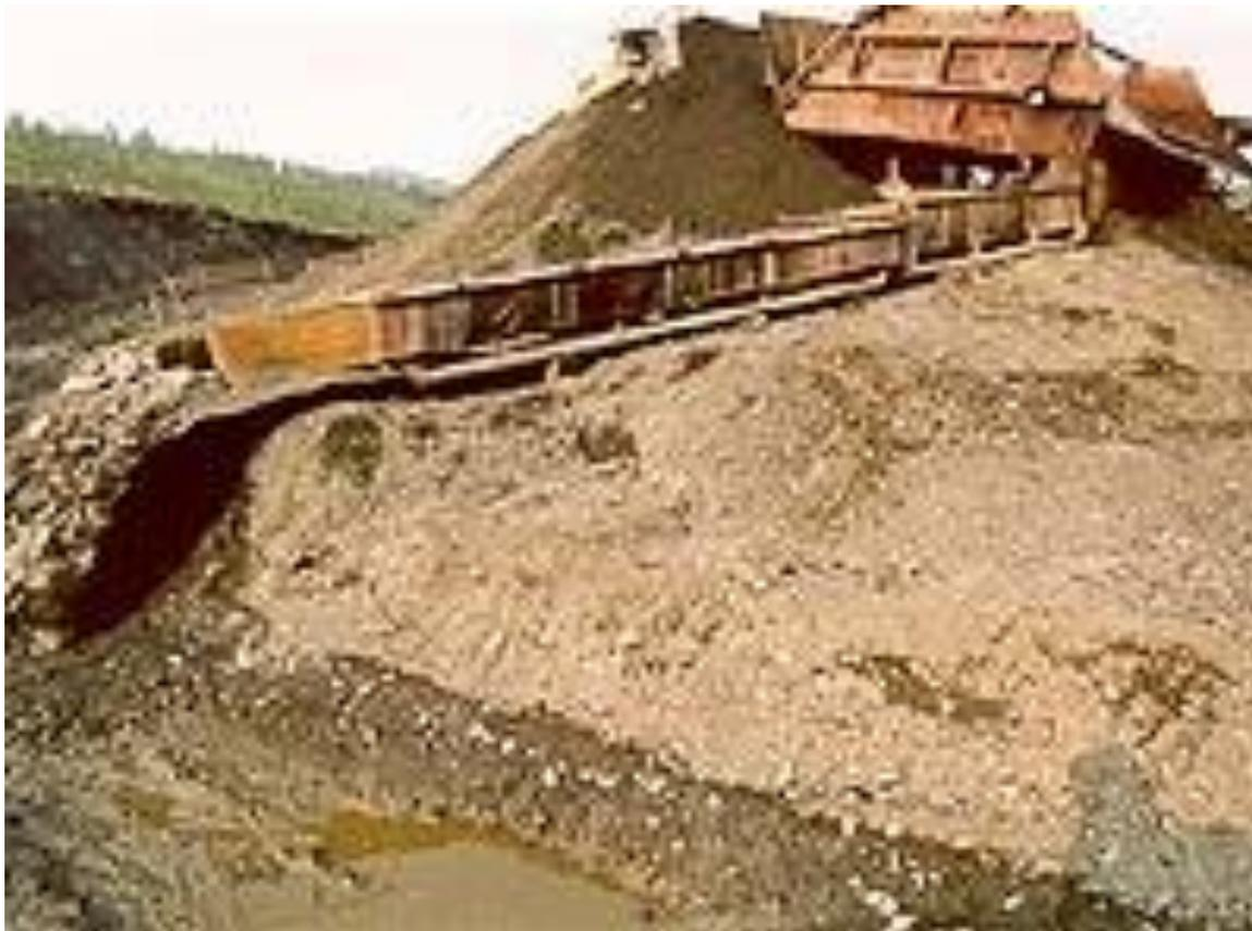
Переработка россыпного месторождения золота с помощью промывочного прибора
