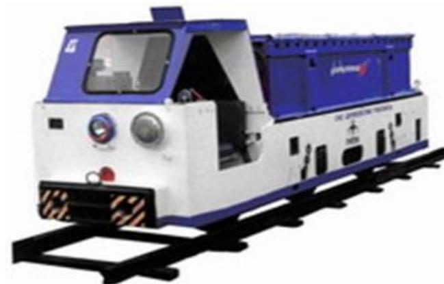
Платформы перестановочные используются для принудительного перемещения одиночных вагонеток с одного пути на другой, расположенный параллельно. Основная задача электровозов аккумуляторных – транспортировка составов вагонеток по подземным железным дорогам узой колеи.
