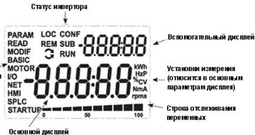
Одновременное отображение 3 переменных на дисплее.
