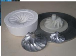
*Используется прогрессивная технология не имеющая аналогов в нашей стране, которая позволяет получать тонкостенные сложнопрофильные алюминиевые отливки с высокой точностью за счет использования эластичной модели, по которой формируется разовая гипсовая форма для получения отливки колеса компрессора методом вакуумного всасывания.*
