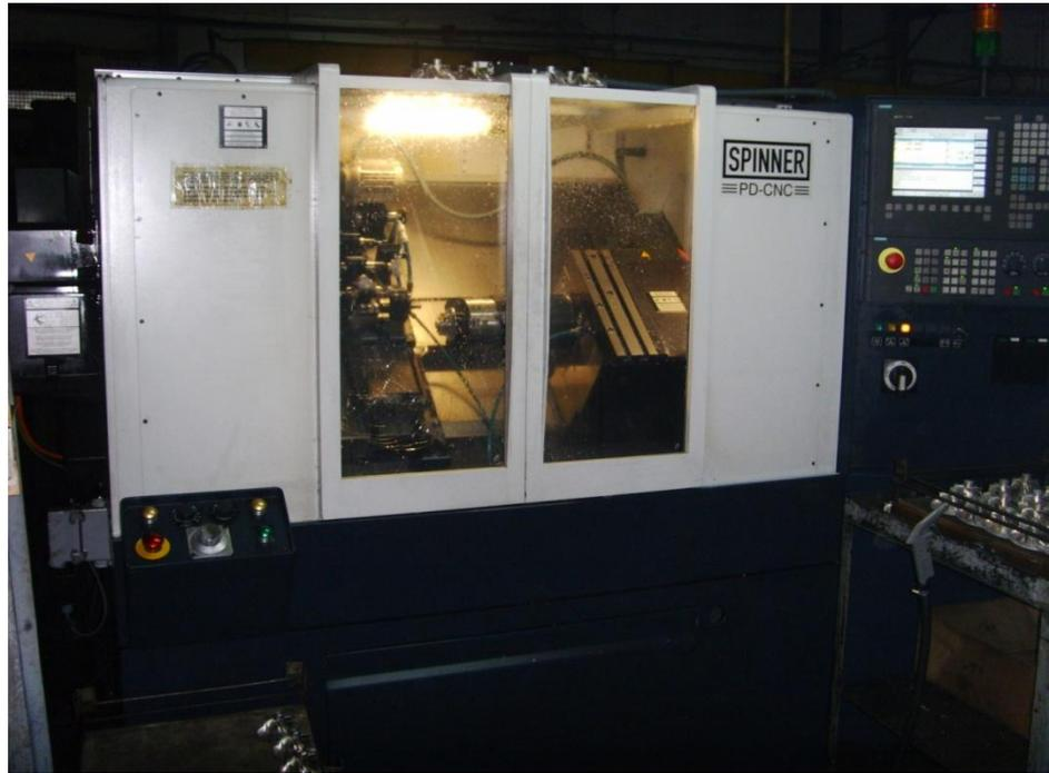
Токарный станок SPINNER с контршпинделем,
