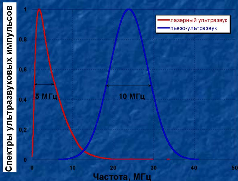
Продольное разрешение дефектоскопа определяется длительностью УЗ импульса
