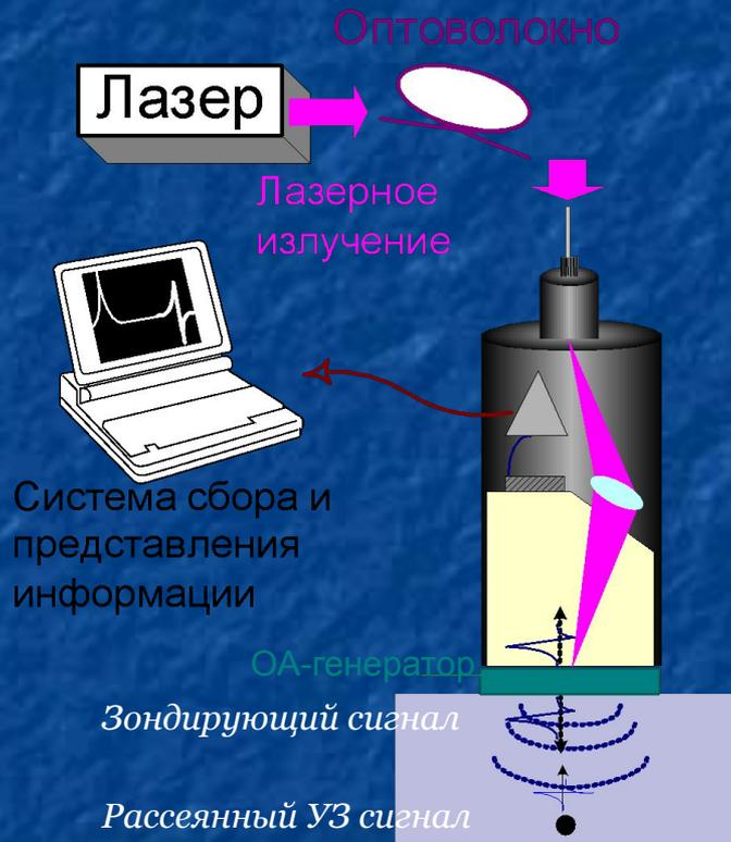
**Контактный лазерно-ультразвуковой метод основан на:**
