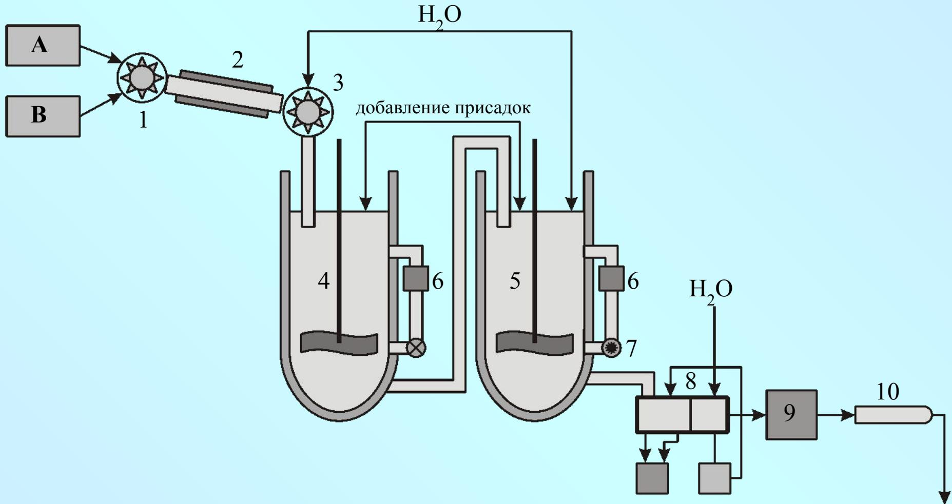
1 – скоростной смеситель, 2 – реактор, 3 – смеситель, 4 – кристаллизатор I, 5 – кристаллизатор II, 6 – узел термического воздействия, 7 – узел ультразвуковой обработки (РАМП), 8 – фильтр, 9 – смеситель промытого осадка с водой, 10 – вакуумная распылительная сушка.
