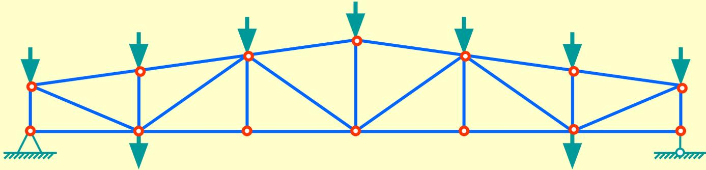
В реальной ферме крепления стержней в узлах жёсткие. В расчётной схеме крепления стержней считают шарнирными, что связано с реализацией принятого упрощающего предположения о возможности пренебречь усилиями, возникающими при изгибе.
