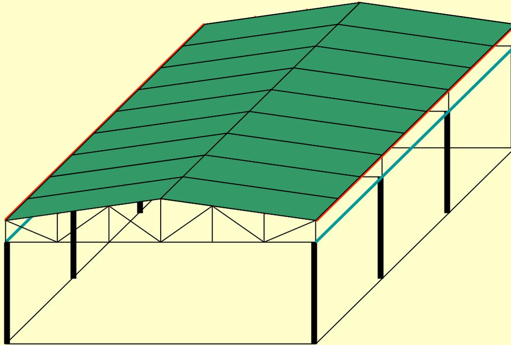
Как видно, нагрузка на ферму передаётся через продольные прогоны, которые прикреплены к узлам фермы.
