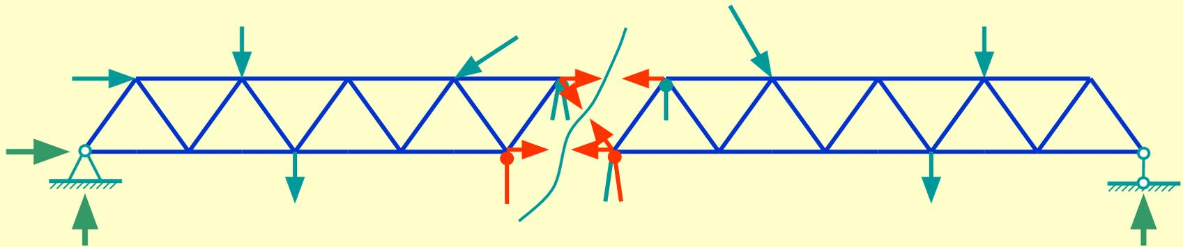
Можно рассмотреть равновесие любой из образовавшихся частей фермы. Для рассматриваемой части «разрезанные» стержни служат опорами. Их реакции входят в систему внешних сил, приложенных к рассматриваемой части фермы.
