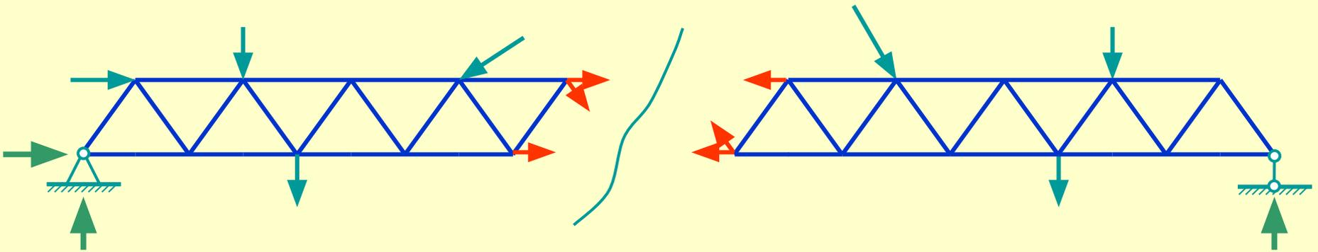
Любая из частей фермы находится под действием плоской системы сил, для которой можно составить только три независимых уравнения равновесия. По этой причине сечение, по возможности, проводится через три стержня фермы.
