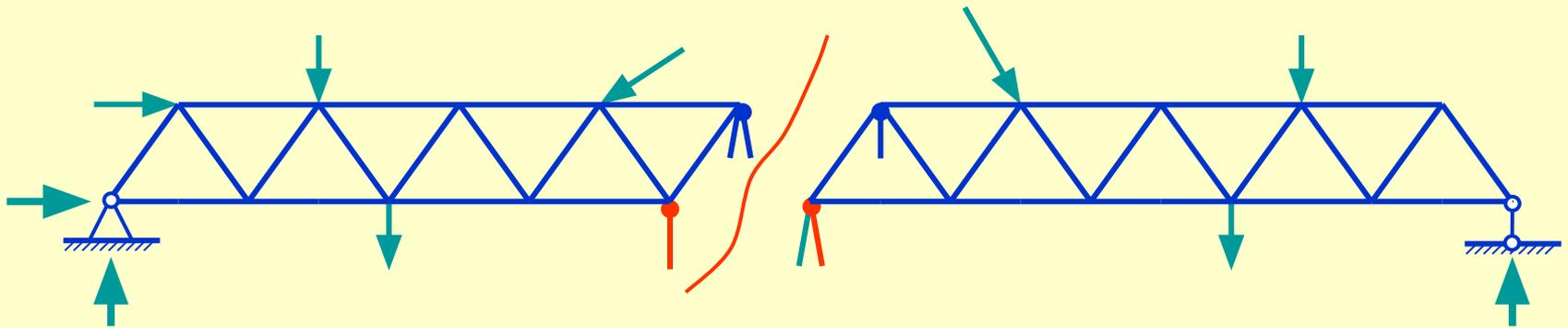
Метод сквозных сечений состоит в том, что ферма разделяется сечением на две части и рассматривается равновесие одной из этих частей. Сечение проводится через стержень, в котором необходимо определить усилие.
