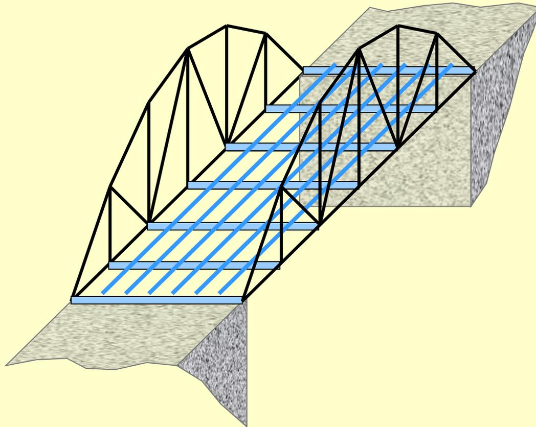
Эксплуатационная нагрузка через поперечные балки передаётся на узлы боковых ферм моста.
