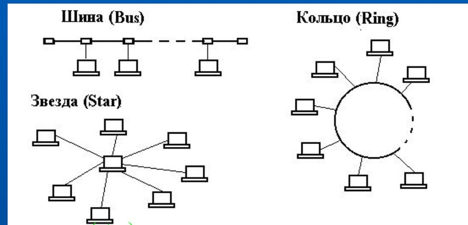
**звездная (star)** - имеется центральный узел, от которого расходятся линии передачи данных к каждому из остальных узлов.
