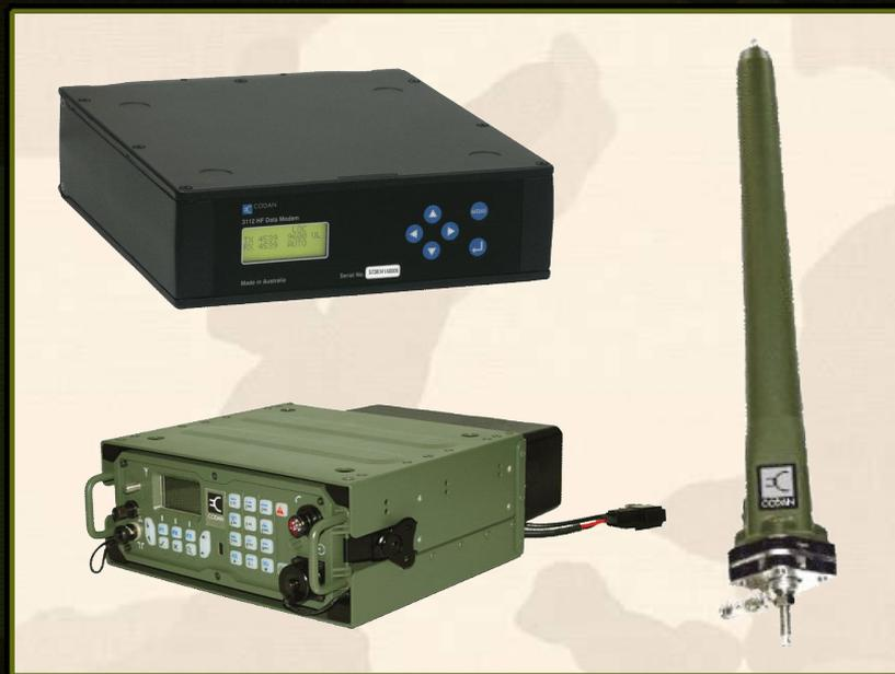
**На рисунке:** Военный модем 3112, Переносной трансивер 2110M, Антенна с автоматическим согласованием 9350M
