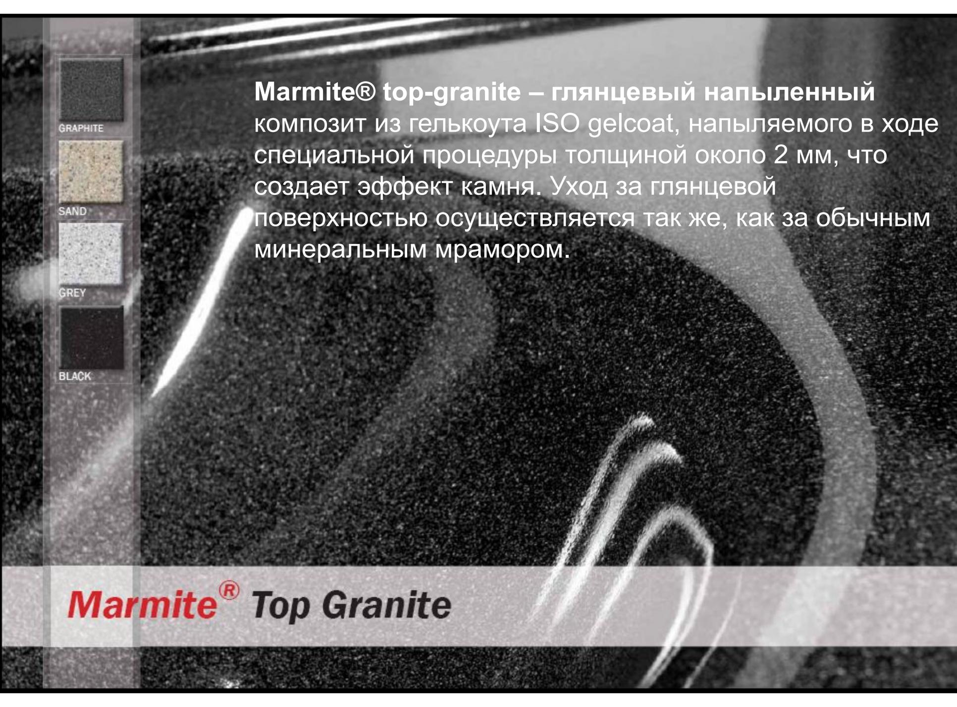
**Marmite® top-granite** – глянцевый напыленный композит из гелькоута ISO gelcoat, напыляемого в ходе специальной процедуры толщиной около 2 мм, что создает эффект камня. Уход за глянцевой поверхностью осуществляется так же, как за обычным минеральным мрамором.
