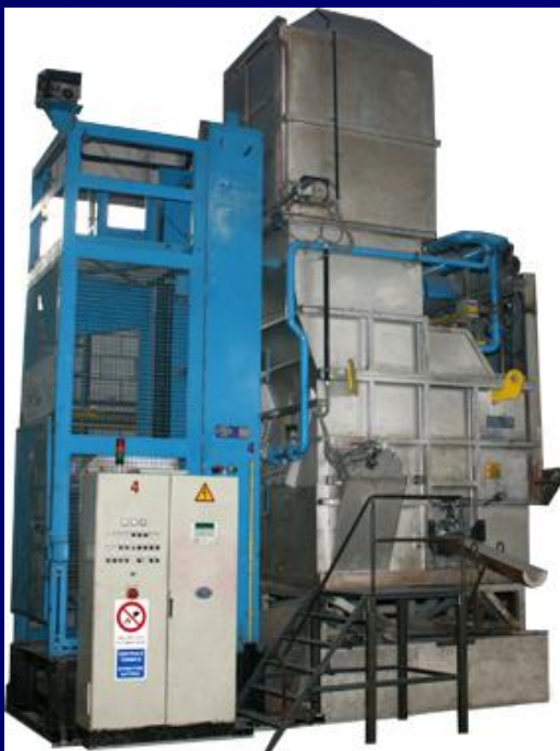
Немецкая газовая плавильная печь « Striko »
