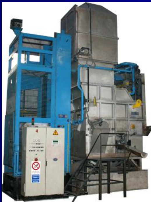
Немецкая газовая плавильная печь « Striko »
