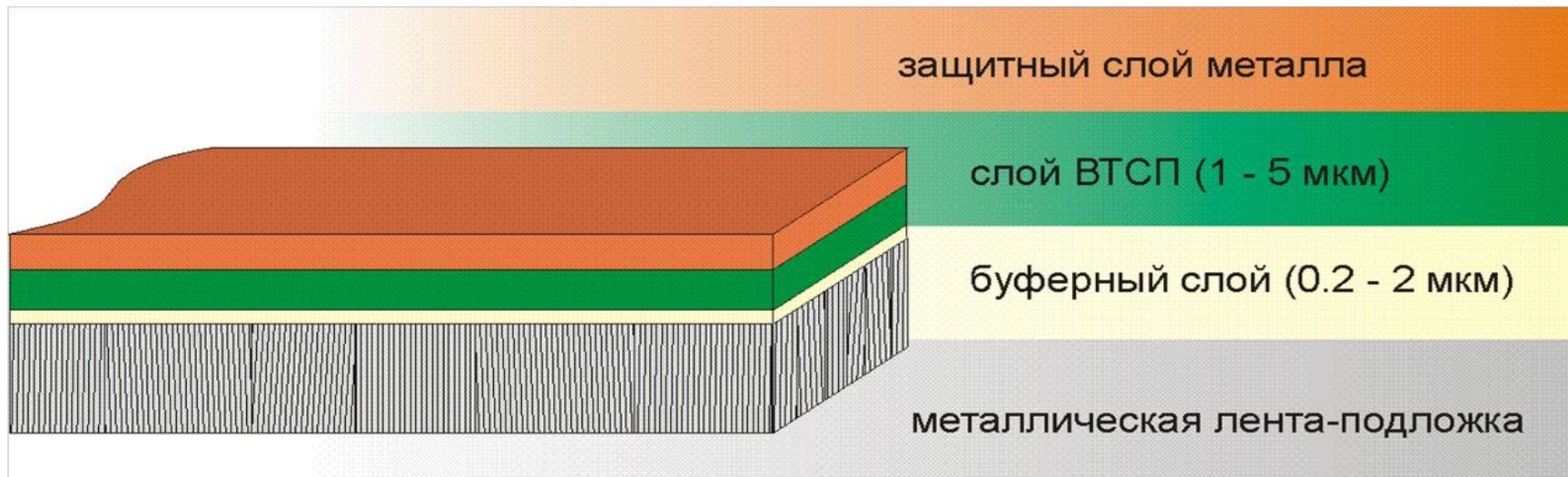
Технологическая концепция компании основана на передаче текстуры (ориентированной кристаллической структуры), созданной в металлической ленте-подложке слою СП через буферные слои.
