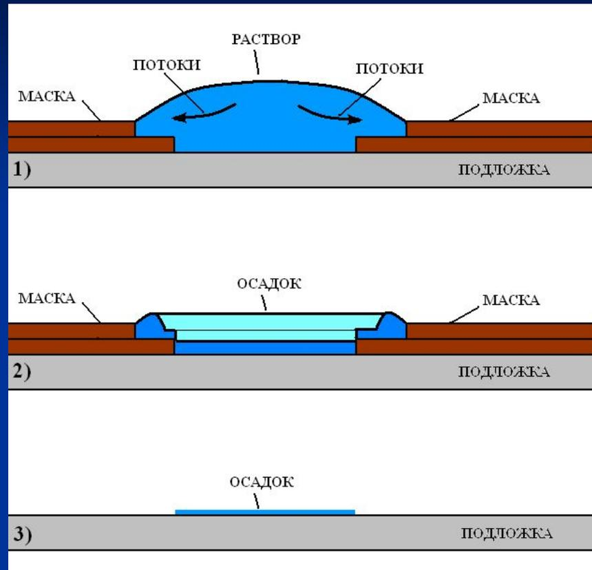
*Способ равномерного нанесения раствора на подложку в случае смачивания материала маски растворителем. 1) Капля, нанесенная в окошко маски, 3) формирование кольца на нижней части маски 2) Сухой твердый осадок после удаления маски.*
