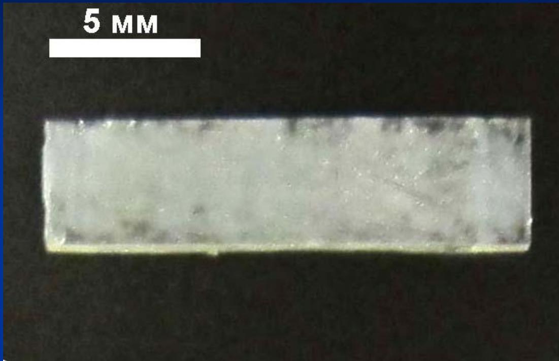
*Изображение образца из частиц, предназначенного для исследований функциональных характеристик сенсорного материала.*
