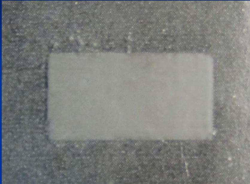
*Оптическое изображение образца, сформированного путем нанесения микрочастиц на клеевое покрытие. Размер образца: 7 мм x 15 мм.*
