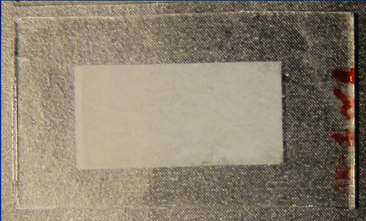
*Изображение образца из частиц, предназначенного для исследований оптических характеристик сенсорного материала. Размер образца: 7 мм x 15 мм.*
