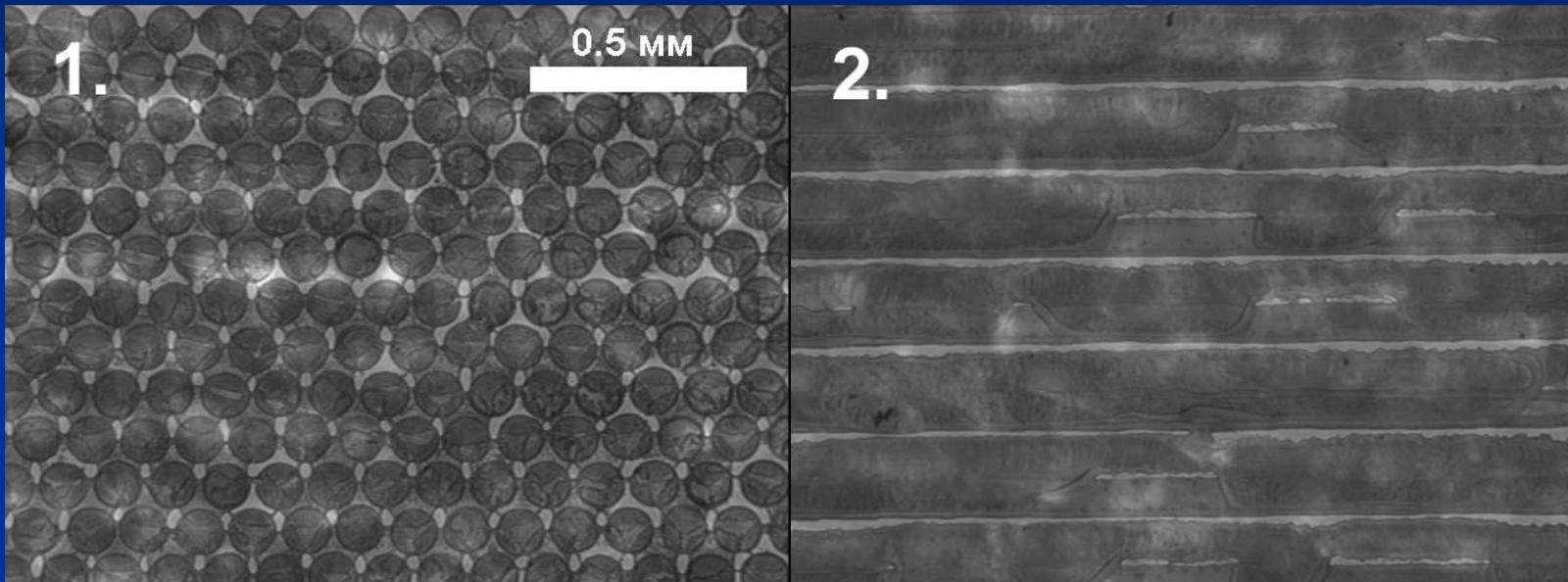
*Различные способы сплошного заполнения в сформированных при помощи Jetlab-II пленочных покрытиях.*
