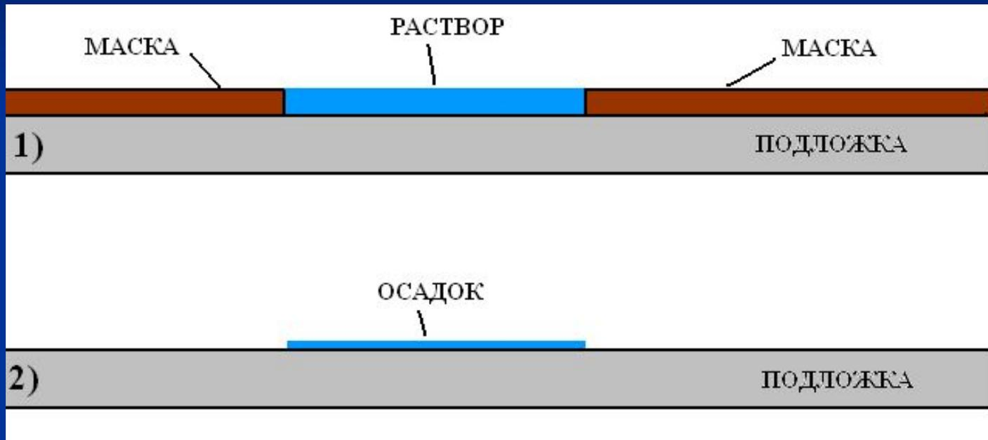
*Способ равномерного нанесения раствора на подложку в случае несмачивания материала маски растворителем. 1) Капля, нанесенная в окошко маски, 2) Сухой твердый осадок после удаления маски.*
