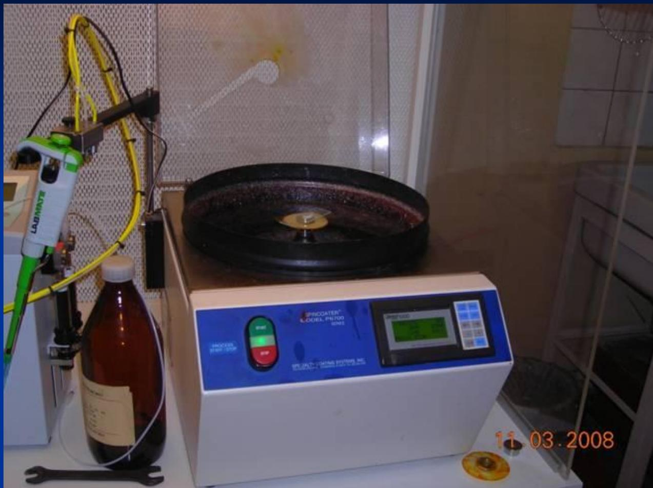
*Система нанесения пленочных покрытий Spin Coater P6700*
