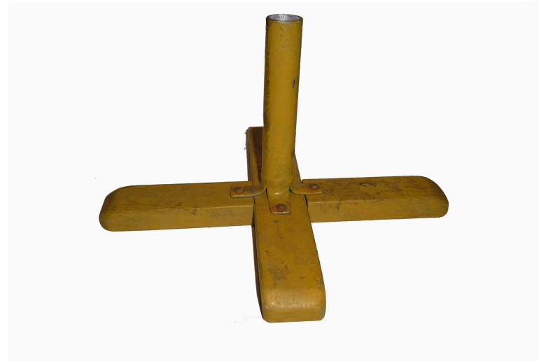
Образец соединения вполдерева – подставка под ёлку.
