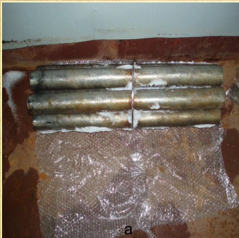
Вид фрагментов чехлов до (а) и после (б) дезактивации
