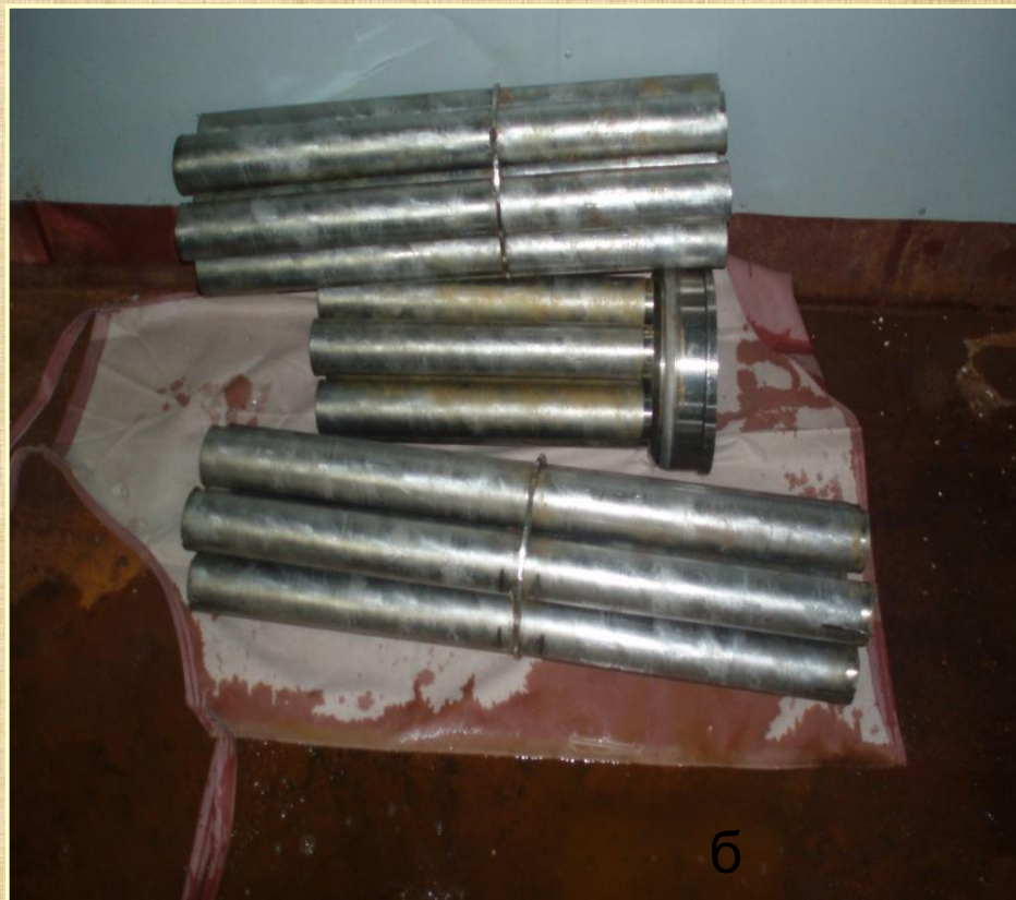
Вид фрагментов чехлов до (а) и после (б) дезактивации
