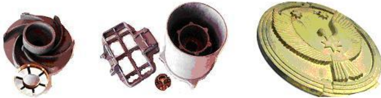
Образцы отливок, полученных литьем по выплавляемым моделям.
