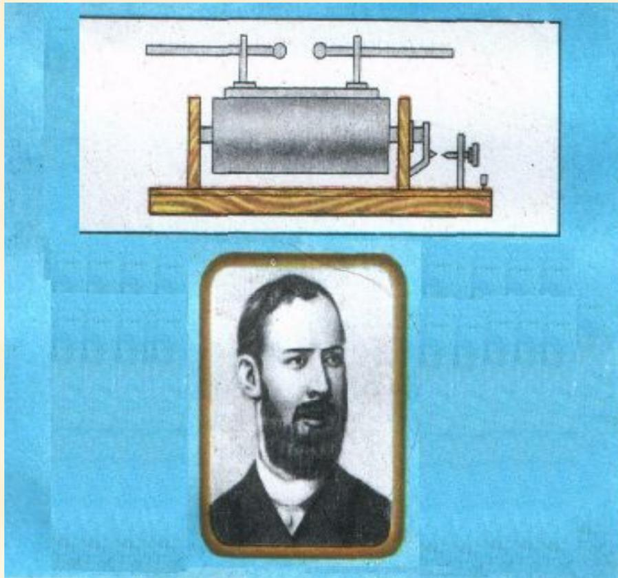
Впервые электромагнитные волны были получены Г.Герцем в его классических опытах выполненных в 1888 – 1889 гг. Для возбуждения электромагнитных волн Герц использовал искровой генератор (катушку Румкорфа).
