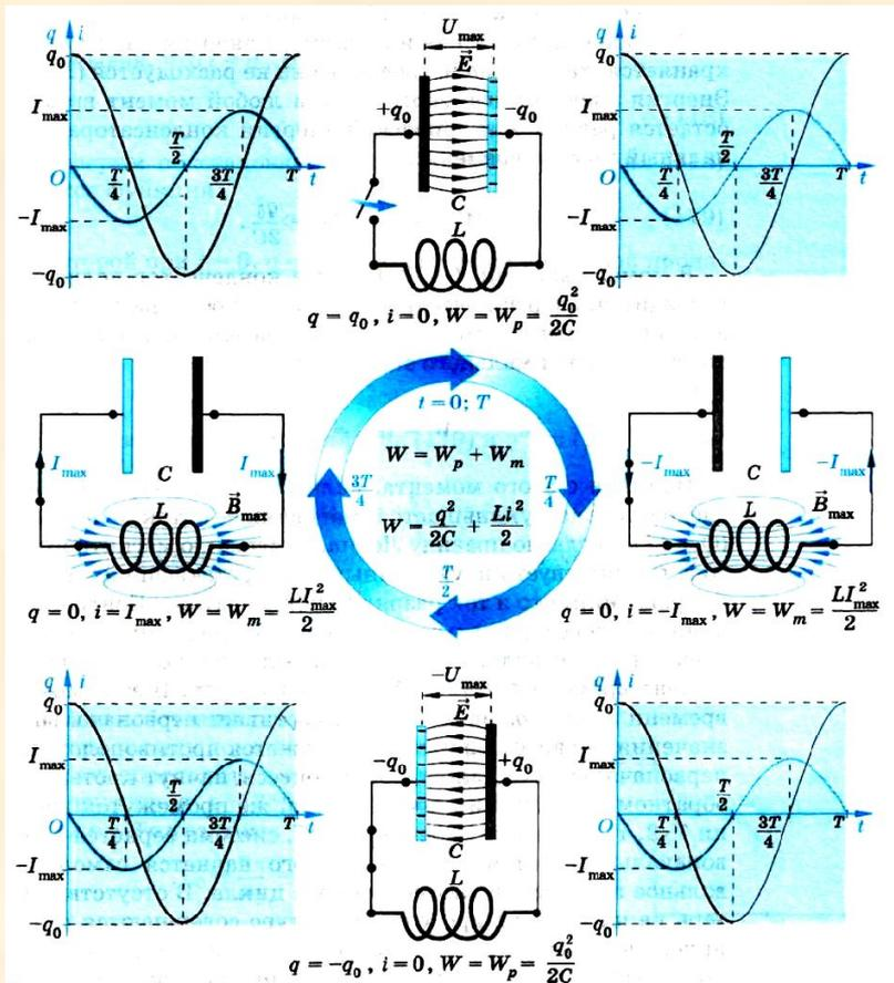
Низкочастотные колебания осуществляются в колебательном контуре. Колебательный контур — цепь, состоящая из последовательно включенных катушки индуктивностью  $L$  и конденсатора емкостью  $C$ .
