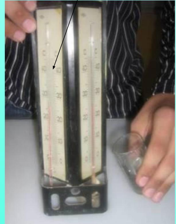
**Температура влажного термометра меньше чем сухого**
