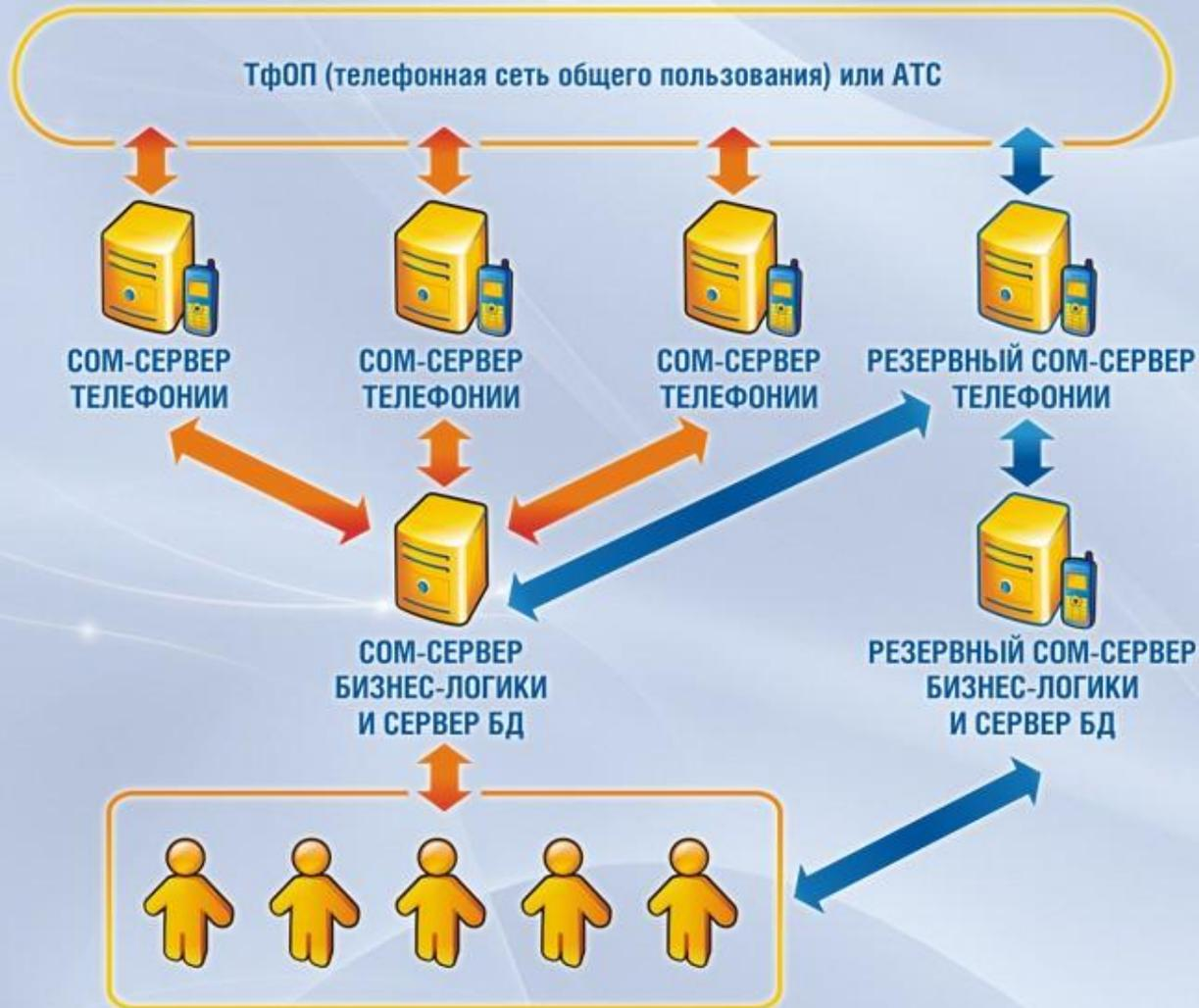
Система резервирования позволит исключить риски, связанные с выходом из строя оборудования.
