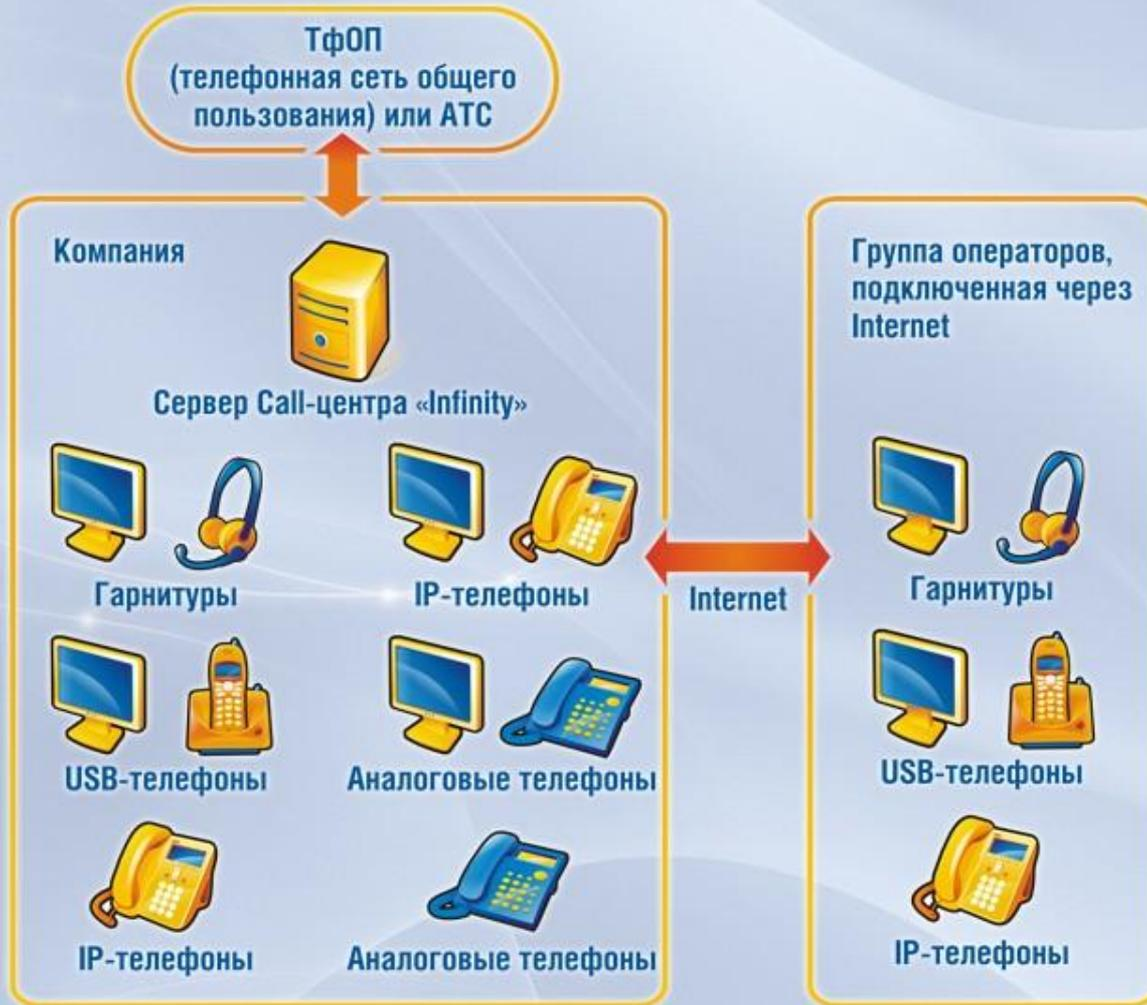
Для выполнения задач по обработке телефонных звонков на сервер устанавливается плата компьютерной телефонии и специальное программное обеспечение Infinity. К серверу телефонии подключаются городские линии. Операторы также подключаются к серверу. В качестве конечных устройств могут выступать: гарнитуры, IP-телефоны, USB-телефоны, аналоговые телефоны.
