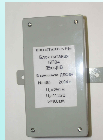
Блок питания БП-04 (взрывозащищенный)
