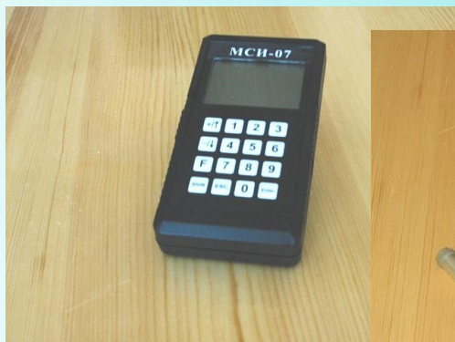
Переносной модуль сбора информации МСИ-07
