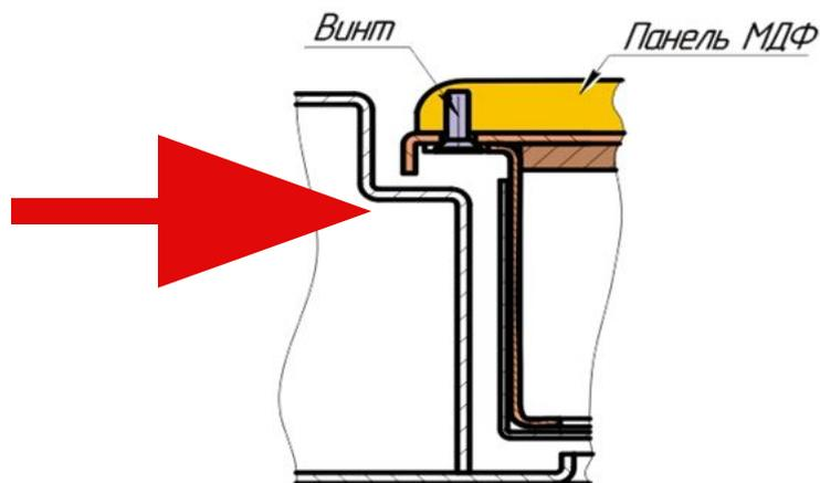
•Перед установкой ДП необходимо подручным инструментом удалить вставки под ДП, в местах, указанных на фото, произвести разметку панели
