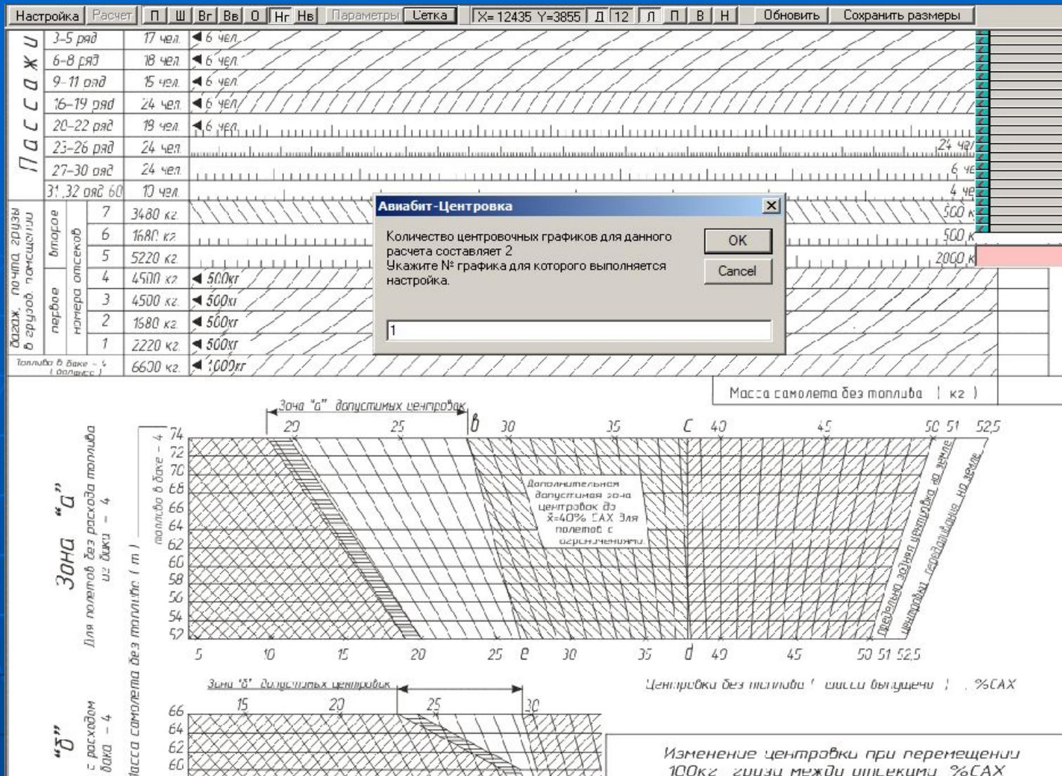
Далее выполняется оцифровка нижней части центровочного графика, причем если для расчета используется несколько вариантов «колодцев», то оцифровывается каждый из них.
