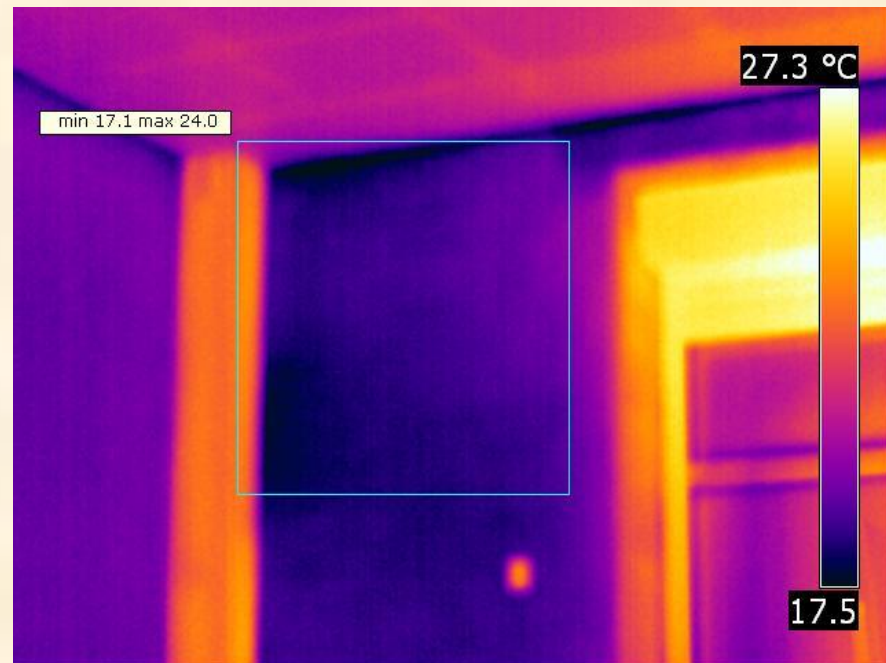
Переохлаждение внутреннего угла до 17°C.
