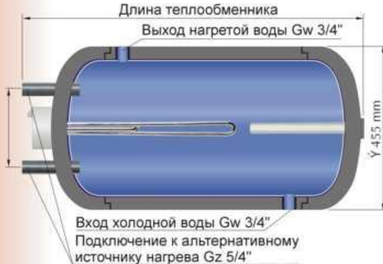
**Теплообменники типа WZ предназначены для подключения к альтернативному контуру нагрева**
