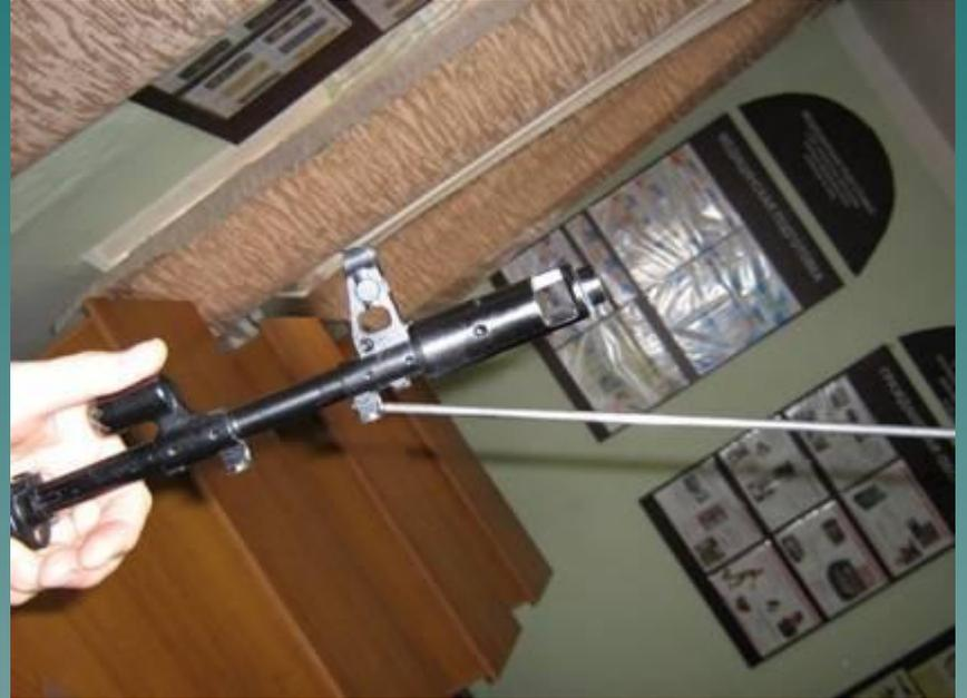
Оттянуть конец шомпола от ствола так, чтобы его головка вышла из-под упора на основании мушки
