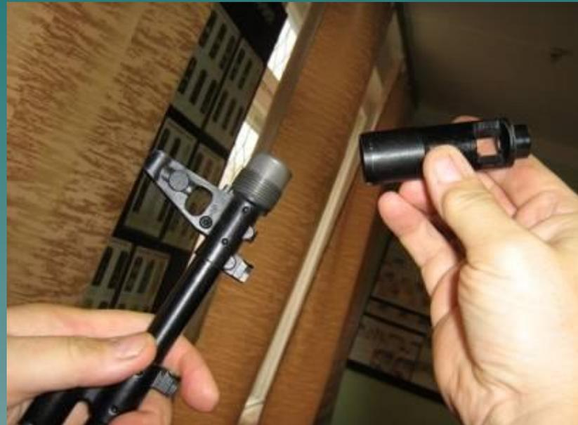
Нажать ногтем указательного пальца на фиксатор и вращая против часовой стрелки, отвинтить его.
