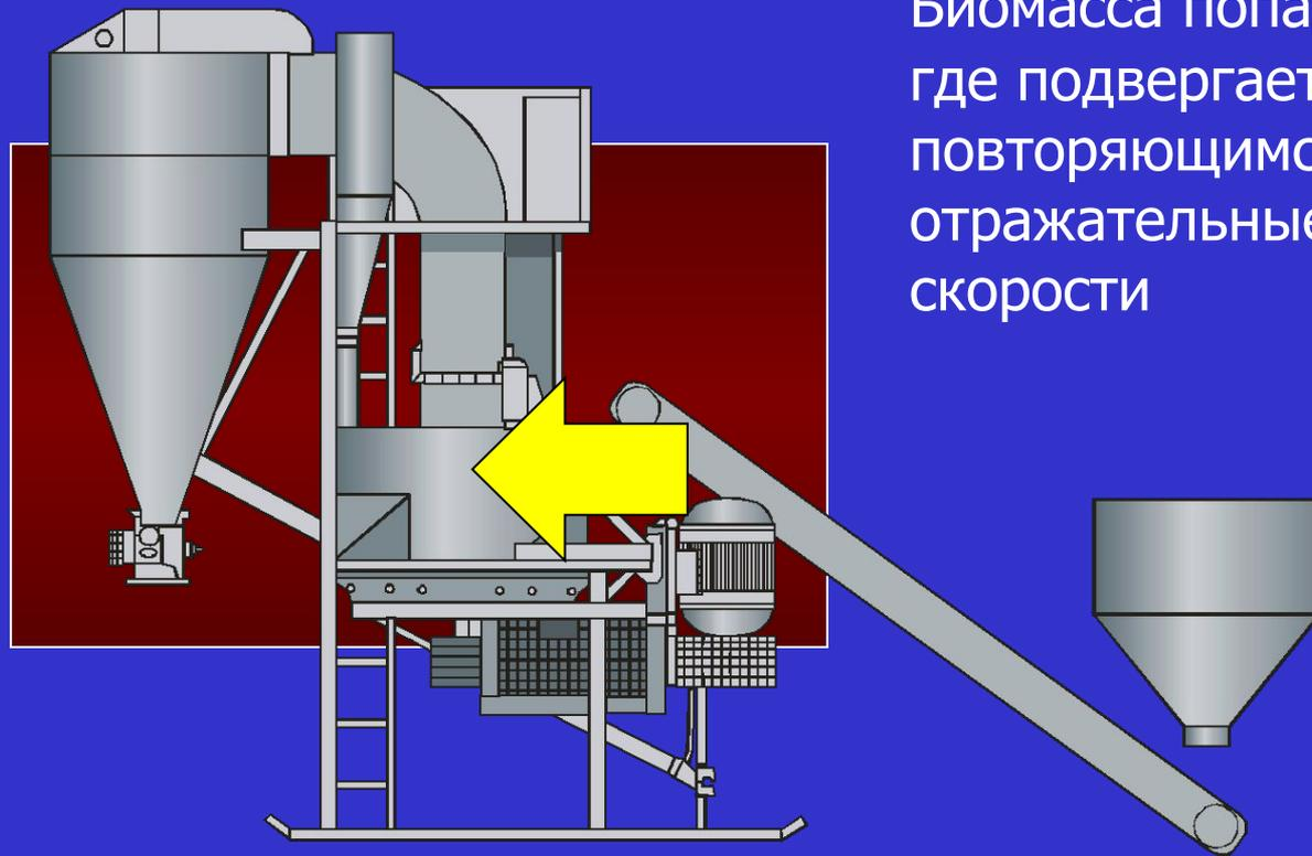
Биомасса попадает в роторную камеру где подвергается многочисленным повторяющимся ударам о ротор и отражательные пластины на большой скорости
