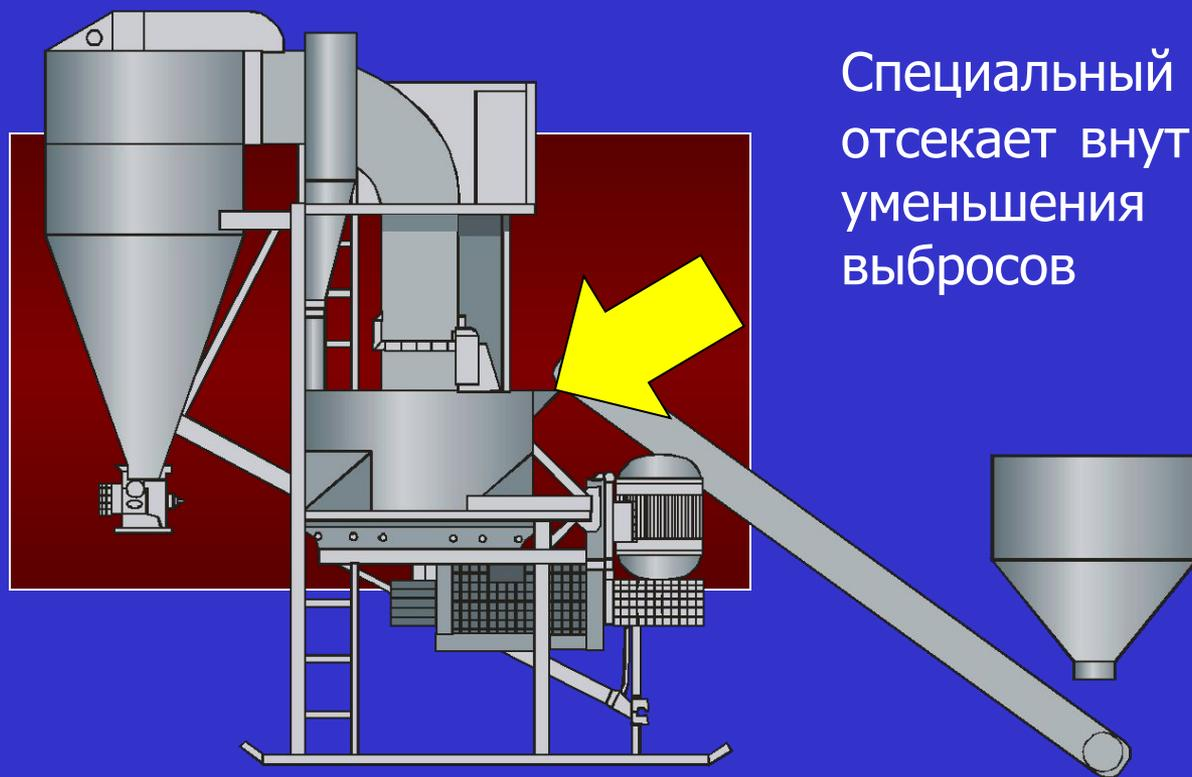
Специальный воздушный замок отсекает внутреннюю камеру, для уменьшения пыли и обратных выбросов
