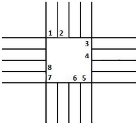
Номера на полосах движения соответствуют позициям в векторе, который подается на вход методу переключения светофоров.
