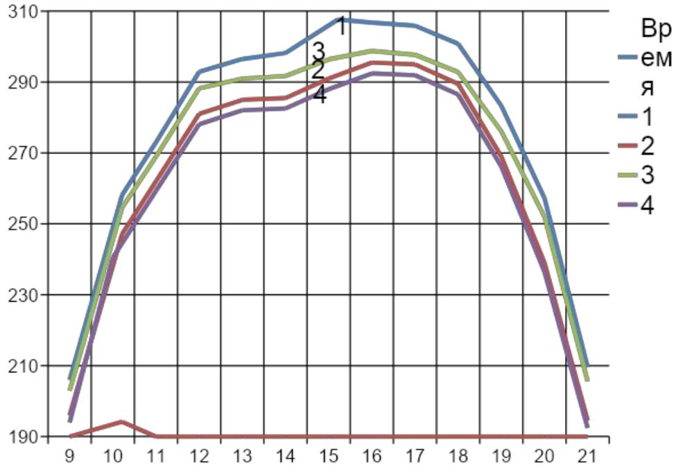
Профиль значений стоимостных функционалов в дневное и вечернее время при малой нагрузке, создаваемой требованиями третьего сервисного класса, и
