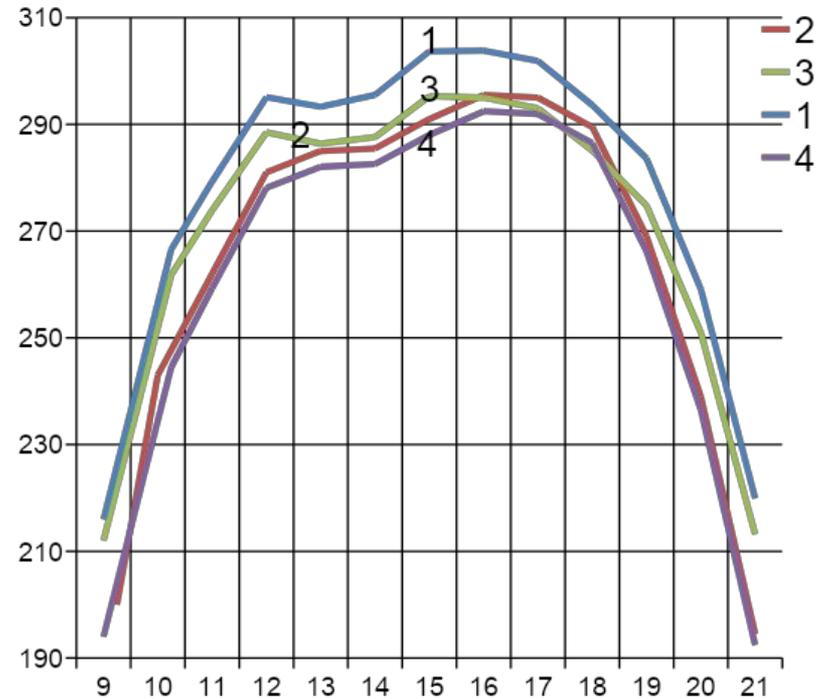
Профиль значений стоимостных функционалов в дневное и вечернее время при большой нагрузке, создаваемой требованиями третьего сервисного класса, и  $H_3 = 0,4$
