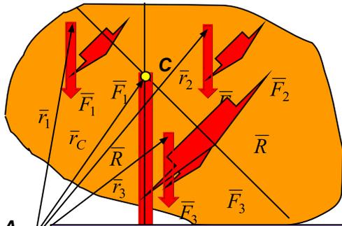
С учетом принятых гипотез при определении положения центра тяжести можно использовать формулы для определения положения центра параллельных сил:
