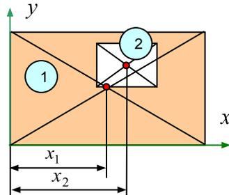
2. **Метод отрицательных площадей** – так же, как и в методе разбиения, сложная фигура разбивается на совокупность простых фигур, для которых известны положения центра тяжести или легко определяются, но при наличии отверстий или пустот удобно их представление в виде “отрицательных” областей. Например, следующая фигура вместо разбиения на 4 обычных прямоугольника, может быть представлена как совокупность двух прямоугольников, один из которых имеет отрицательную площадь:
