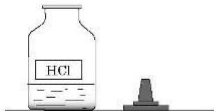
Рис. 1. Як треба ставити пробку, відкриваючи склянку з реактивом
