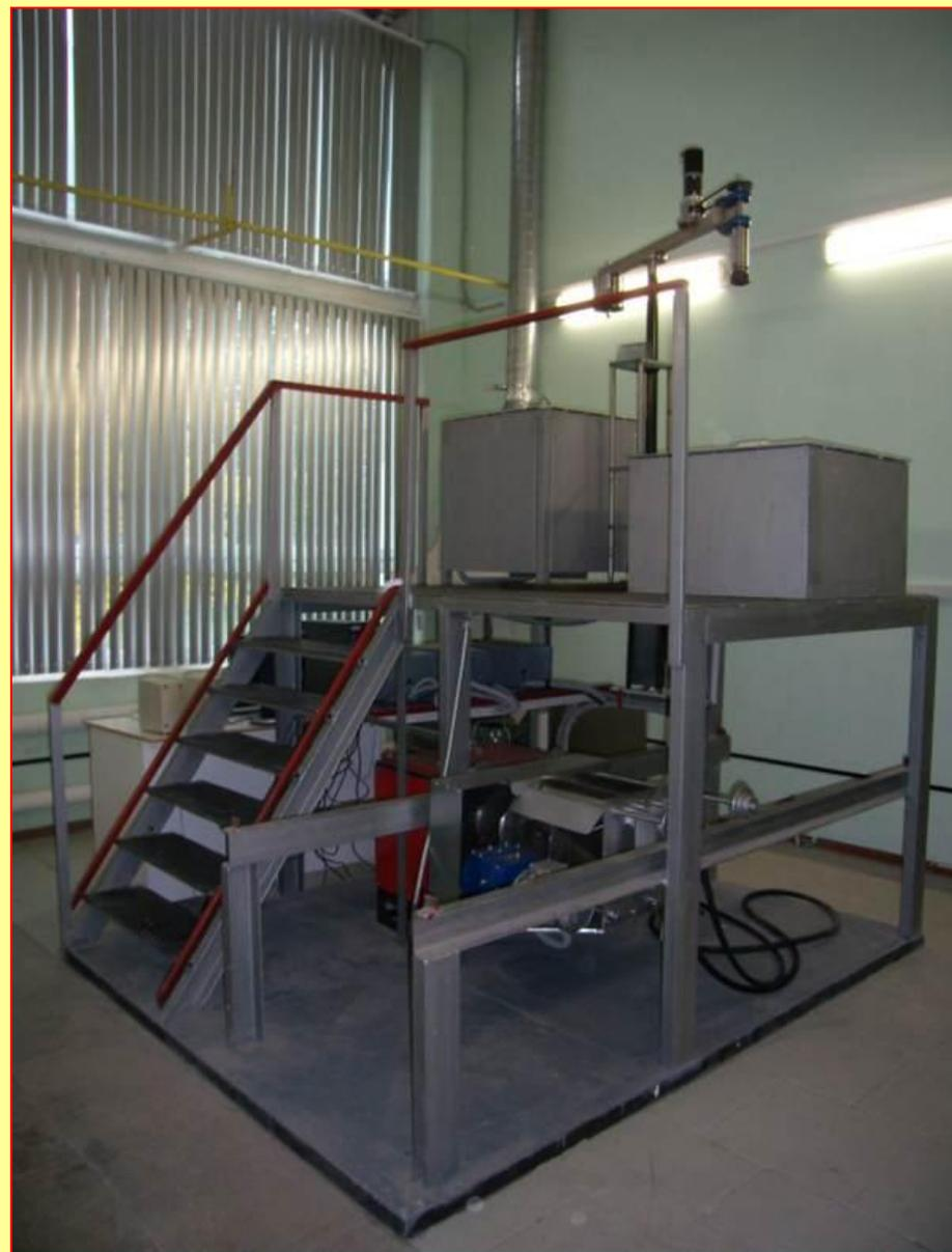
**Минипечь, укомплектованная стекломешальной машиной, с объемом платинового тигля ~ 300 мл и платиновой мешалкой для отработки процессов варки и выработки стекол экспериментальных составов**
