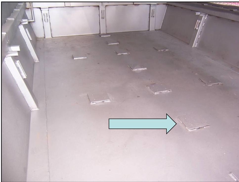
В качестве опор на днище ванны – пластины толщиной 10 мм для тяжело нагруженного режима.
