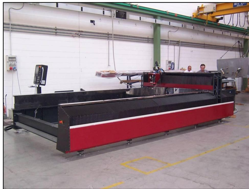
Рама станка, пазы направляющих и приводная система отделены от ванны и не испытывают влияния веса больших и тяжелых заготовок
