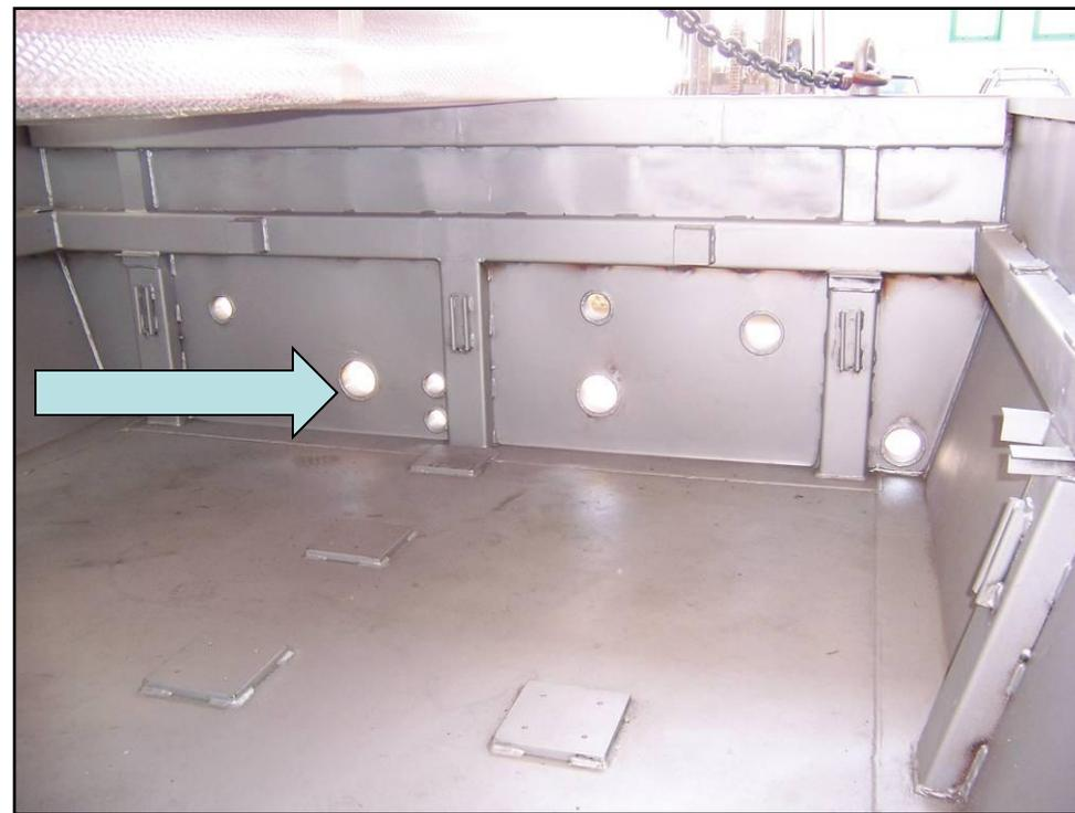
На задней усиленной стенке ванны расположены соединители для устройства удаления абразива
