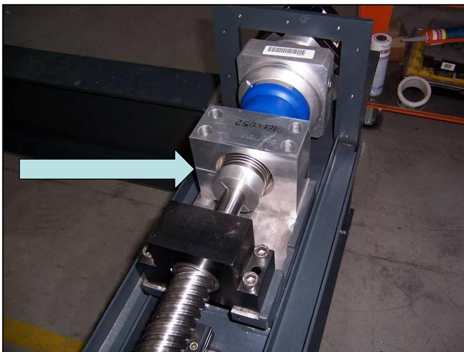
Шариковинтовая пара (ШВП) : муфта редуктора с двойным креплением
