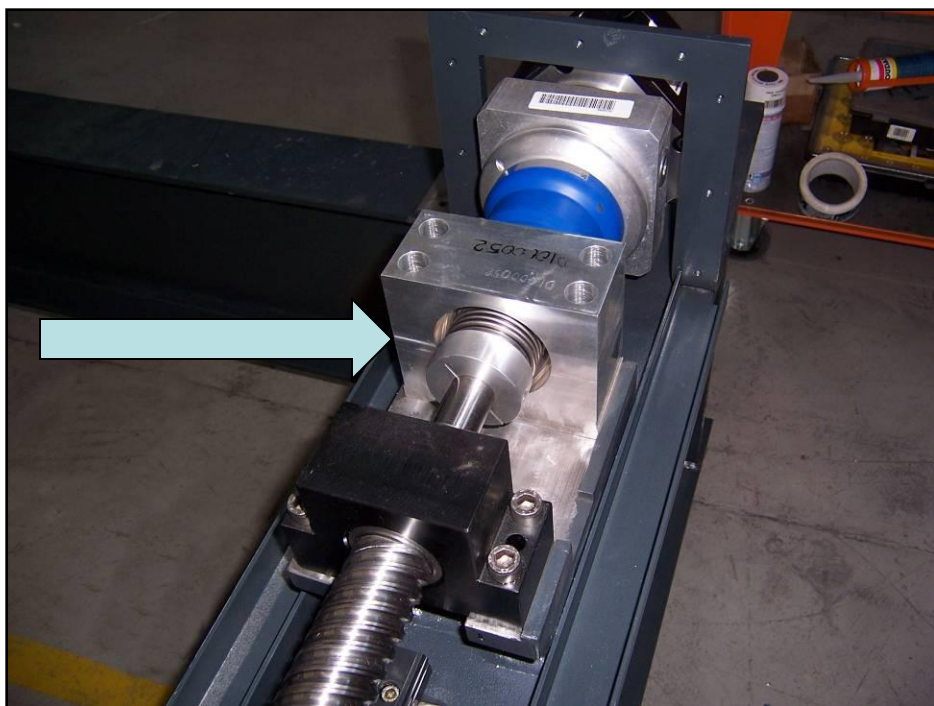
Шариковинтовая пара (ШВП) : муфта редуктора с двойным креплением
