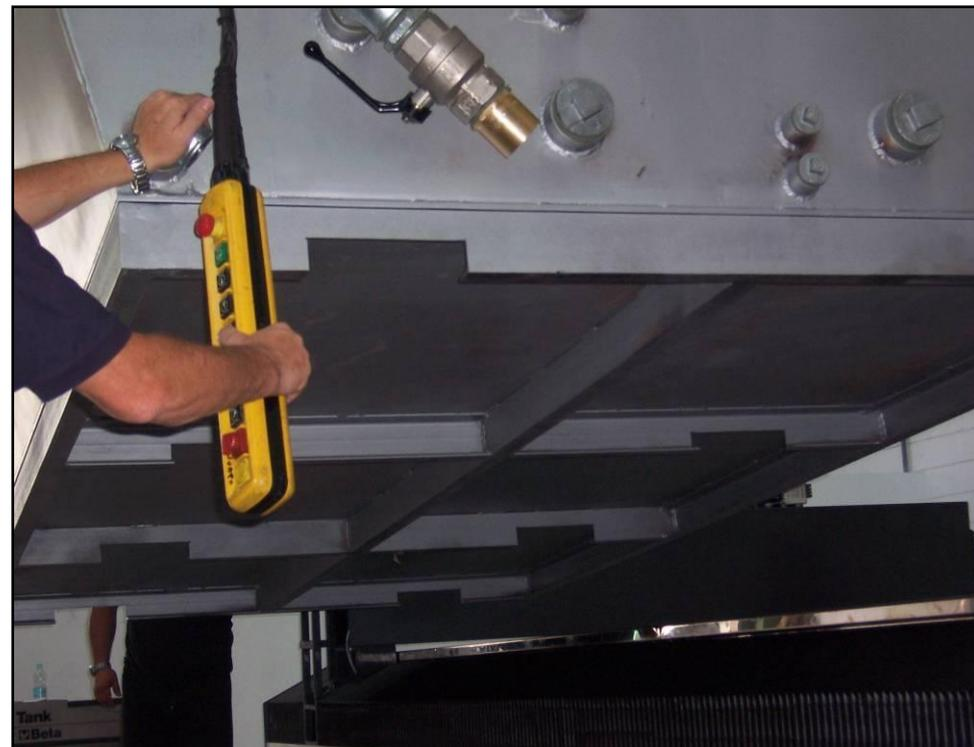
Днище ванны (нерж. 10 мм) предназначено для работы в тяжело нагруженном режиме, рама ванны является опорной поверхностью для сплошной тяжелой заготовки.
