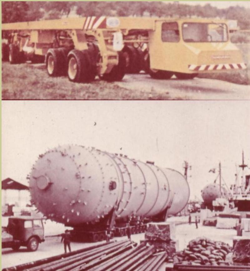
Тяжеловесные грузы (до 5000000Н) перевозят по автострадам и железным дорогам на многоосных платформах. Их «пассажиры» - части корпусов океанских судов , локомотивы турбогенераторы, энергоблоки и так далее.
