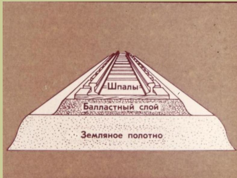
При прокладке железнодорожных путей рассчитывают давление поездов на земляное полотно. Для насыпи не годятся рыхлые породы. Балластный слой должен состоять из щебня, песка и гравия.
