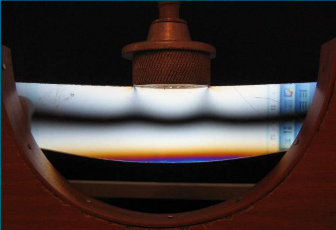
Рост напряжения в пластине гораздо более заметен по сравнению с предыдущим опытом!
