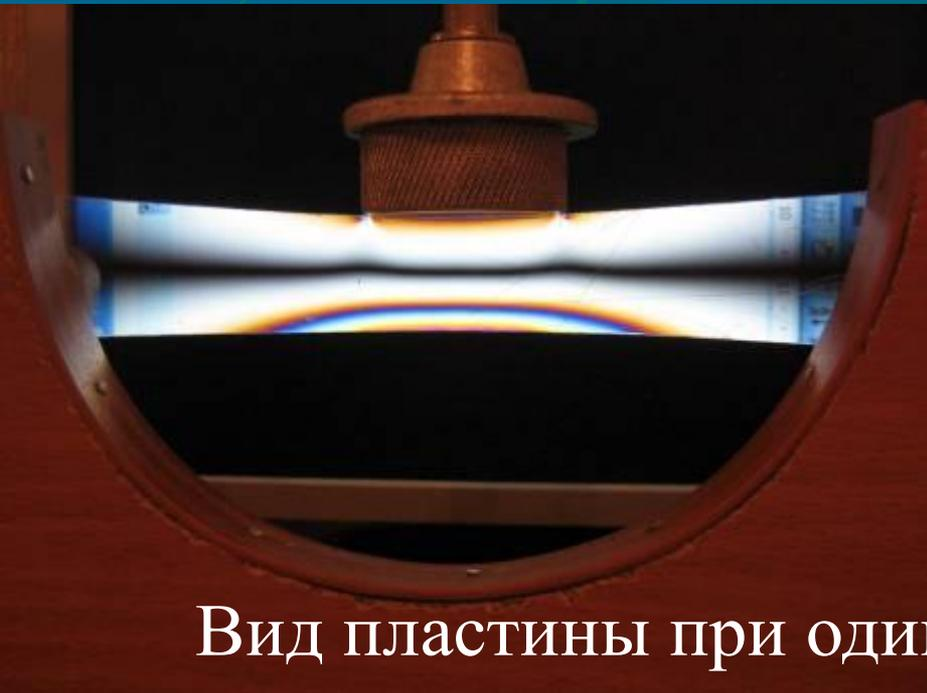
Вид пластины при одинаковом давлении сверху
