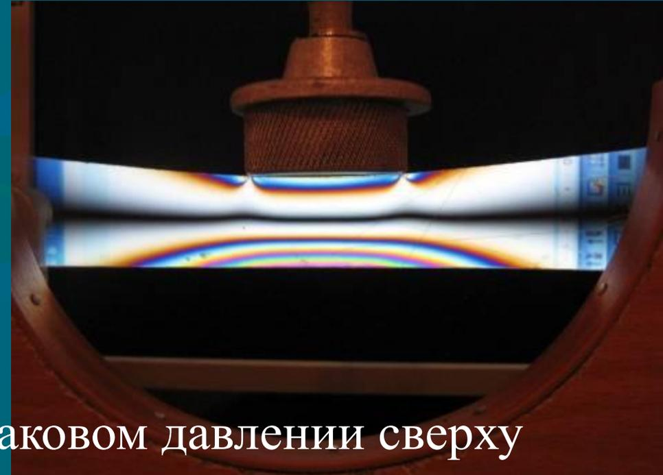
Пластина «вогнутостью» вверх
