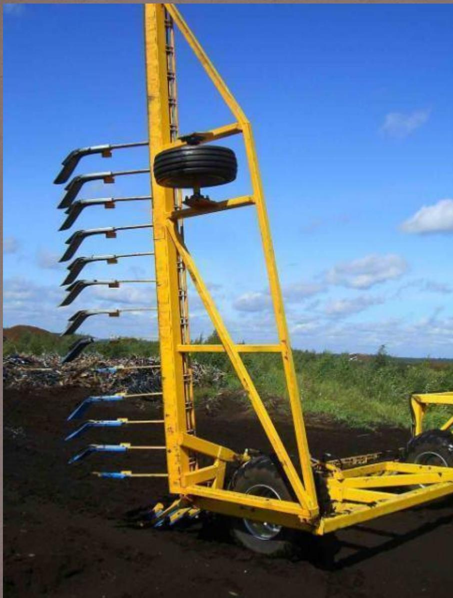
Использование при добыче торфа пассивных фрез позволяет сохранить исходные ценнейшие свойства торфа. Данная технология добычи обеспечивает сохранность природной, то есть длиноволокнистой структуры и существенно уменьшает долю пылевой фракции.
