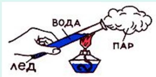
Передача внутренней энергии от одной части тела к другой или от одного тела к другому при их контакте называется теплопроводностью.
