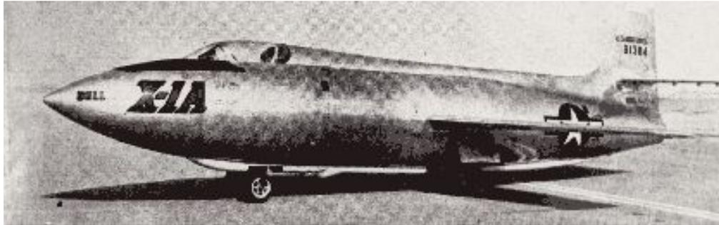
Экспериментальный самолет с ЖРД X1-A, 1953, США, Чак Игер (сброс с самолета Б-29)
