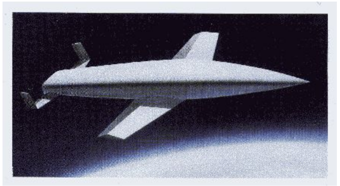
Дальний бомбардировщик с ЖРД (крылатая ракета) Е. Зенгера (проект), Германия, 1944
