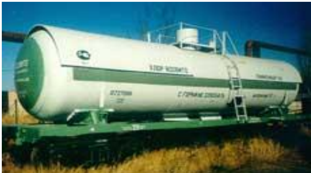
Цистерна для перевозки сжиженного хлора
