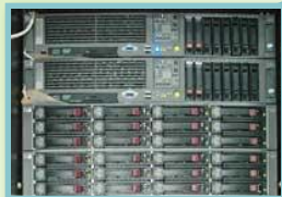
Параллельная СХД НКС-160 6 Тбайт (max-2 Пбайт)
