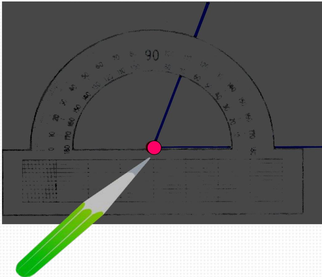
2. Расположить транспортир так, чтобы одна из сторон угла проходила через начало отсчета на шкале транспортира ( т. е **СОВМЕСТИТЬ** с  $0^\circ$ ).
