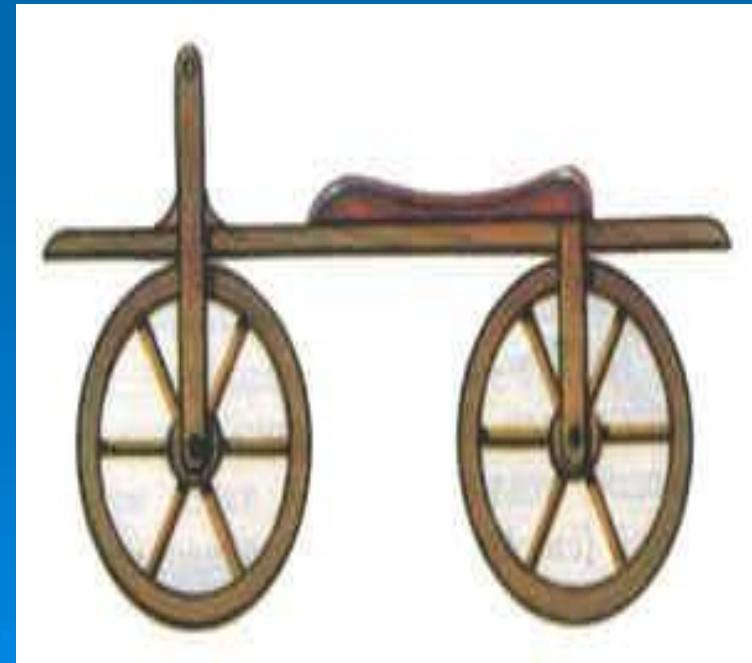
Вторым изобретателем был немецкий офицер Карл Фридрих Дрез. Он оснастил двухколесный самокат управляемым передним колесом.
