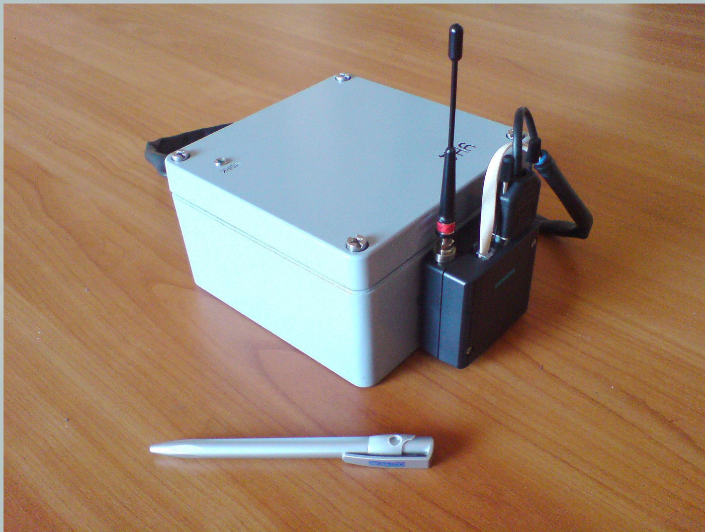
Рисунок 4 - Устройство накопления данных с модемом сотовой связи
