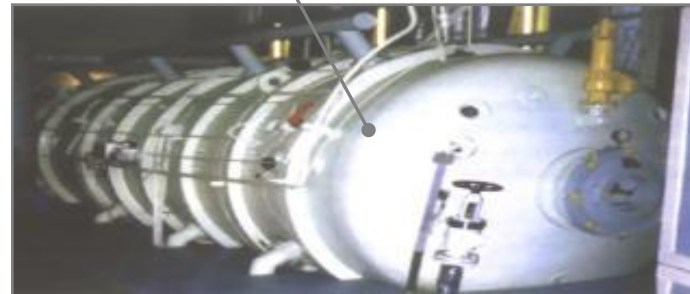
Емкость для криогенного топлива (Производитель ОАО «Уралкриомаш»)
