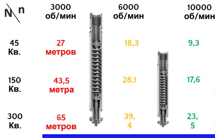
Переход на повышенную частоту вращения позволяет значительно снизить металлоемкость конструкции.
