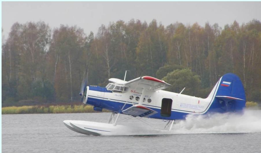
**Поплавковое шасси самолета АН-2В**
