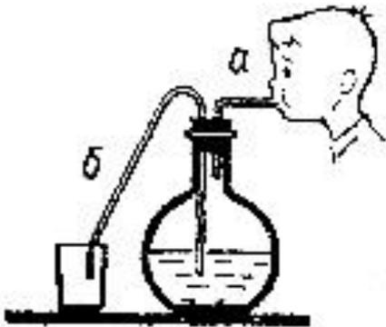
Сосуд плотно закрыт пробкой, в которую вставлены две трубки. Если подуть в трубку *a*, то вода через трубку *б* выливается из сосуда. Будет ли вытекать вода из трубки *a*, если подуть в трубку *б*?
