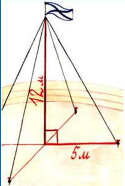
Для крепления мачты нужно установить 4 троса. Один конец каждого троса должен крепиться на высоте 12 м, другой на земле на расстоянии 5 м от мачты.
