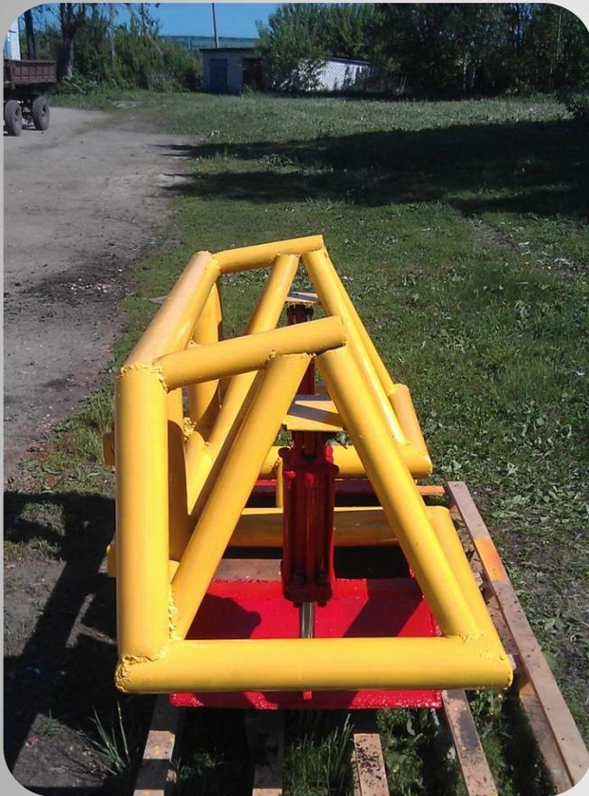
Данная технология позволяет не утилизируя поросли и деревья пересадить их в лесозащитную полосу, тем самым решая 2 проблемы одновременно. Данное устройство агрегируется с тракторами отечественных производителей и просто в изготовлении.
